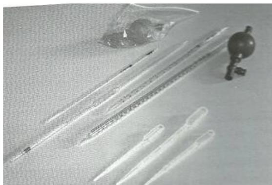
Figura 11: Varie pipette di misurazione
