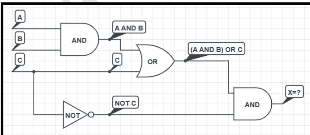
Infine, pensiamo, cosa entra nell'ultima AND? **NOT C** e **(A AND B) OR C** quindi il risultato finale di questo circuito sarà  **$X = (\text{NOT } C) \text{ AND } ((A \text{ AND } B) \text{ OR } C)$**
